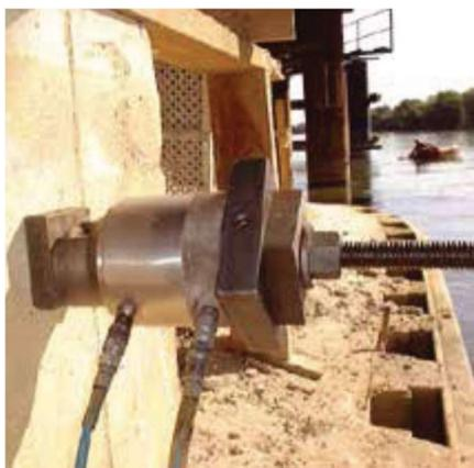
**Figura 15 – Macaco Hidráulico**
