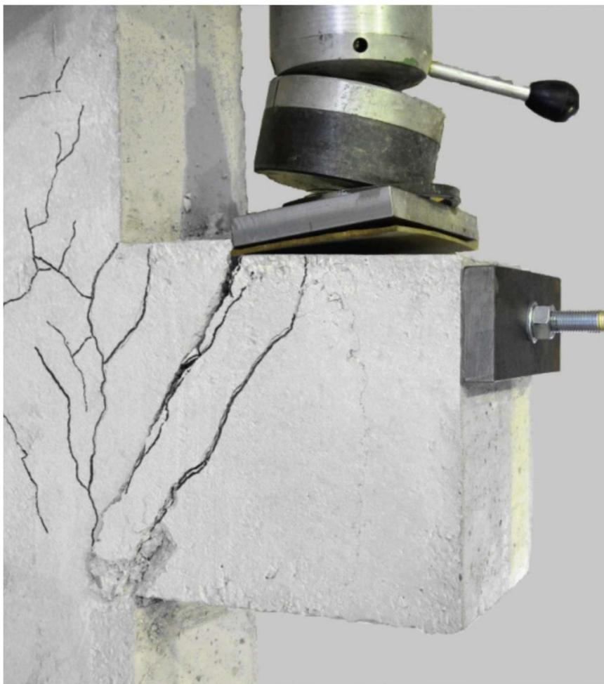
**Figura 22 - Consolo C-I após a falha**
