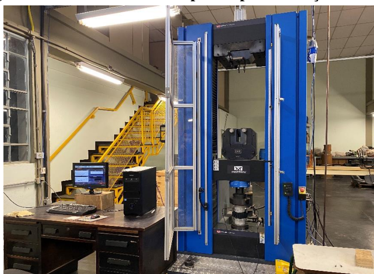
Figura 3.6 – Prensa INSTRON pronta para execução do ensaio
