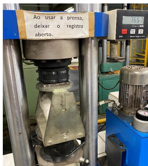
Figura 3.4 – Montagem do ensaio de tração por compressão diametral
