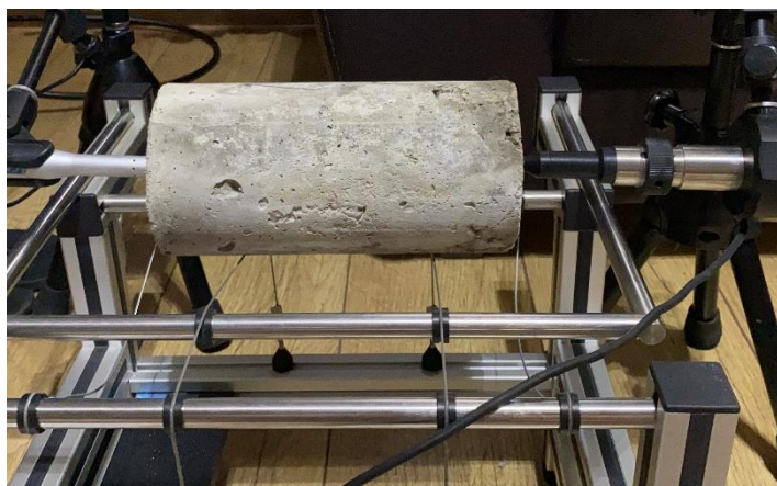
Figura 3.7 – Equipamento Sonelastic® com corpo de prova posicionado para ensaio.
