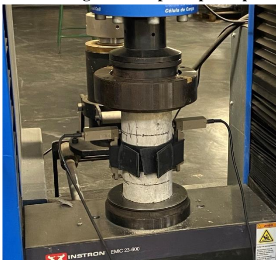
Figura 3.5 – Montagem do corpo de prova para o ensaio
