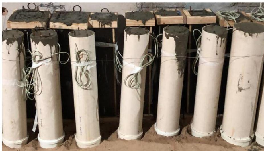
A desforma dos pilares e preparo das superfícies foram realizadas dez dias após a concretagem dos núcleos e pilares de referência. Antes da aplicação do reforço, todos os núcleos foram submetidos a um tratamento superficial com a utilização de disco diamantado acoplado
