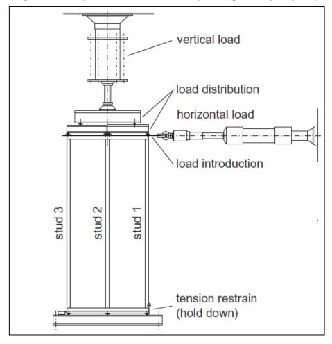
Figura 3.9 – Esquema de ensaio utilizado por Lange e Naujoks (2007)
