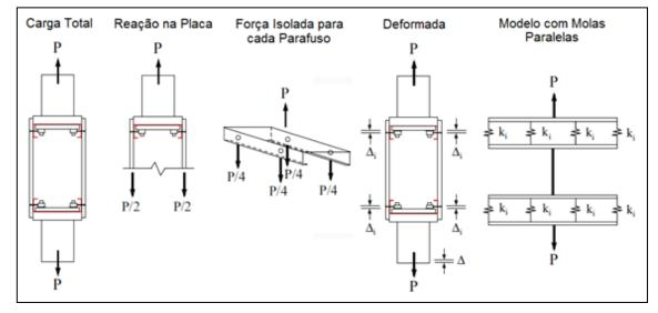
Figura 3.31 - Detalhes da determinação dos parâmetros isolados
