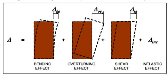
Figura 4.1 – Efeitos que contribuem para o deslocamento lateral de um painel
