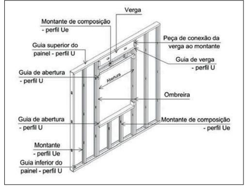
Figura 2.5 – Desenho esquemático de painel estrutural com abertura
