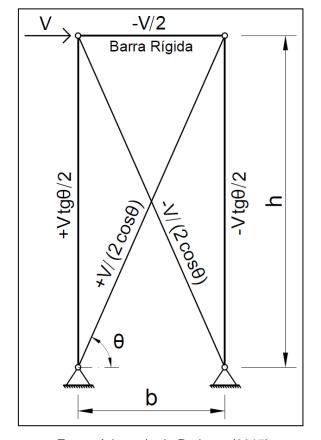
Figura 5.1 – Esforços normais no modelo de diagonais equivalentes
