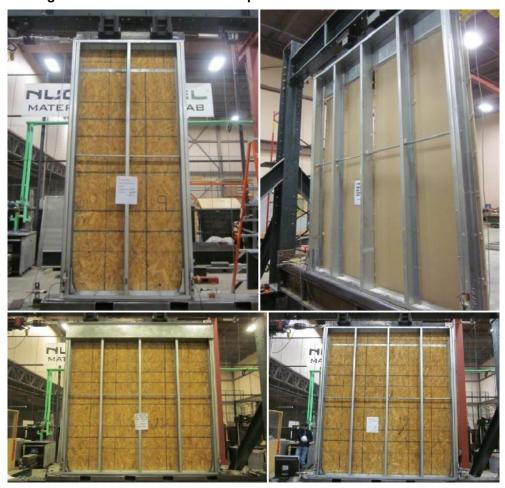
Figura 3.14 – Características dos painéis de cisalhamento ensaiados
