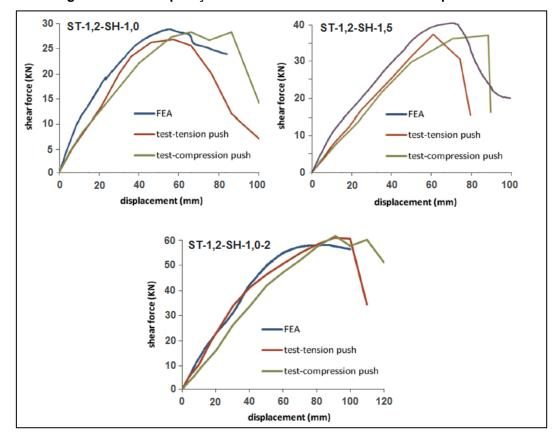
Figura 3.23 – Comparação entre os resultados numérico e experimental
