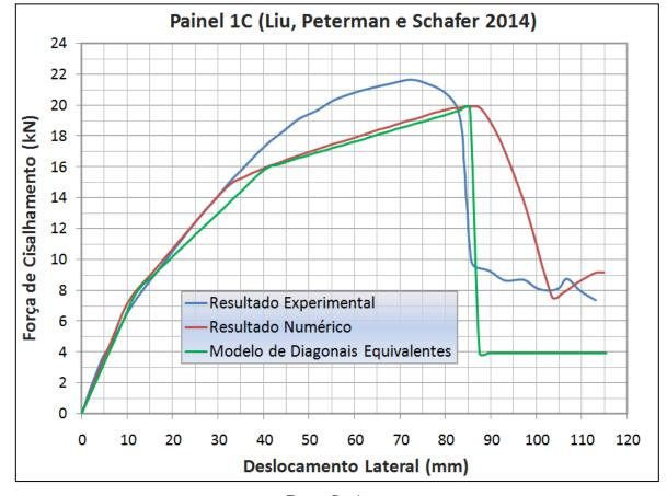
Figura 5.3 – Resultados obtidos a partir dos modelos numérico e simplificado
