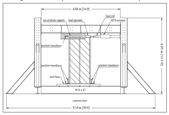
Figura 3.15 – Detalhe esquemático do ensaio ao cisalhamento dos painéis
