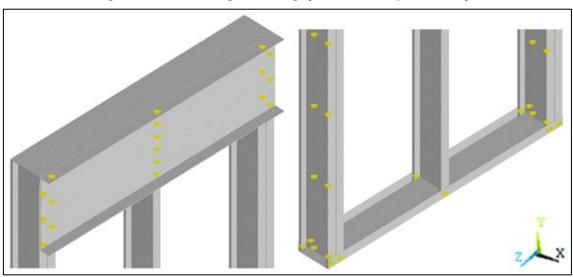
Figura 4.12 - Modelagem das ligações entre os perfis de aço
