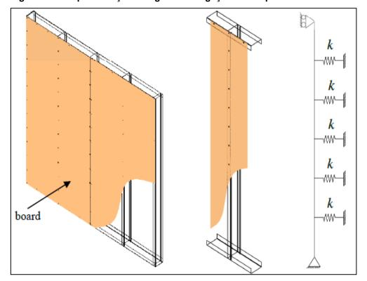
Figura 3.1 - Representação da rigidez das ligações entre perfil e revestimento
