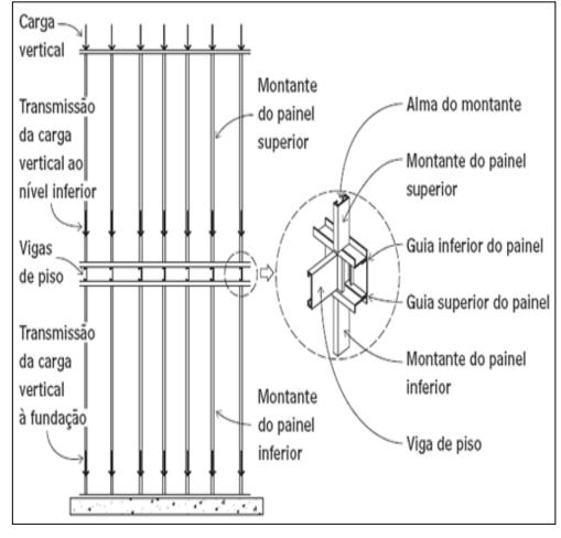
Figura 2.4 - Transmissão da carga vertical à fundação
