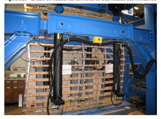
Figura 3.29 – Ensaio em escala real com tiras de OSB fixadas aos montantes
