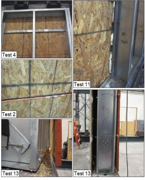
Figura 3.18 - Modos de falha observados nos painéis ensaiados
