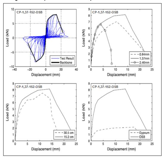
Figura 3.32 – Resposta do caso base aos parâmetros variados nos ensaios
