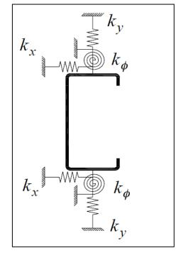
Figura 3.26 - Representação esquemática das molas laterais e rotacional
