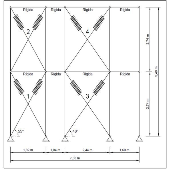
Figura 5.9 – Modelo simplificado de molas equivalentes
