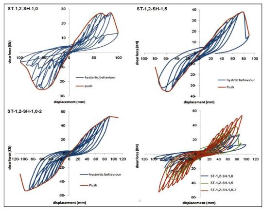
Figura 3.21 - Caracterização histerética dos painéis ensaiados ao cisalhamento
