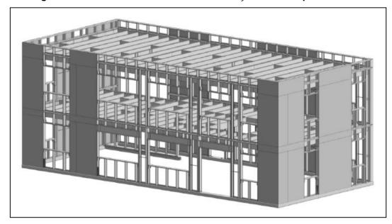
Figura 3.34 – Modelo tridimensional da edificação estudada pelos autores
