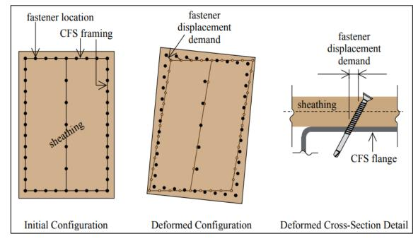
Figura 4.5 – Deslocamento das ligações após a deformação lateral do painel
