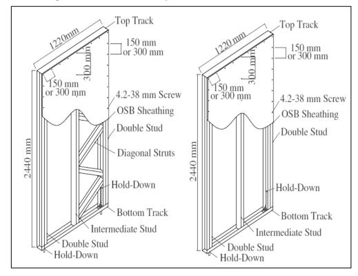
Figura 3.11 – Detalhes dos painéis de cisalhamento avaliados
