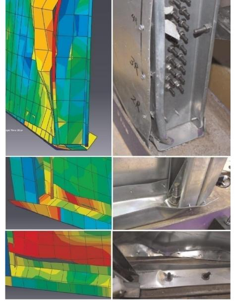
Figura 3.24 – Modos de falha referentes aos estudos numérico e experimental
