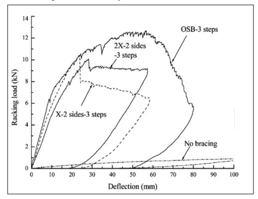
Figura 3.7 – Curvas força *versus* deslocamento lateral
