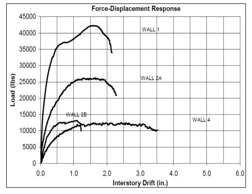
Figura 3.4 – Curvas força versus deslocamento lateral dos painéis analisados
