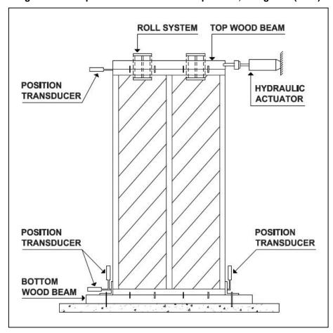
Figura 3.6 – Esquema de ensaio utilizado por Tian, Wang e Lu (2004)
