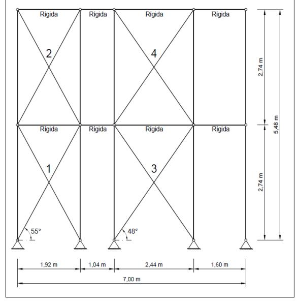
Figura 5.5 – Modelo simplificado de diagonais equivalentes
