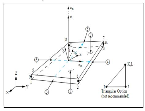
Figura 4.2 - Elemento finito Shell181
