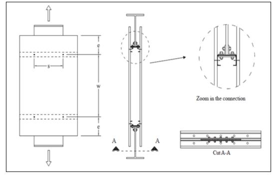
Figura 3.27 – Esquema de ensaio para obtenção da rigidez lateral local
