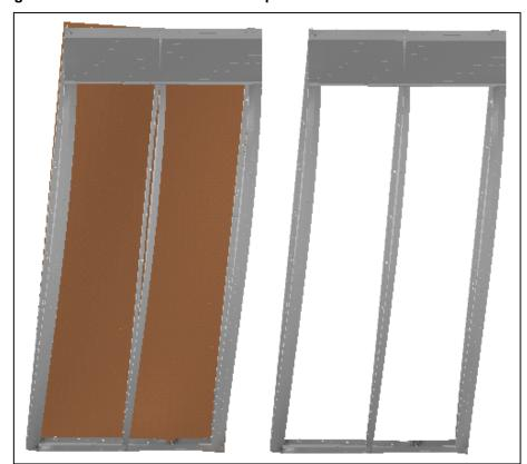
Figura 4.16 - Deformada do modelo após seu deslocamento lateral máximo
