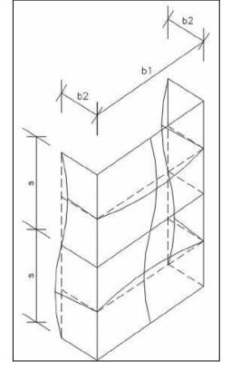
Figura 2.3 - Flambagem dos elementos de um perfil U sujeito a compressão
