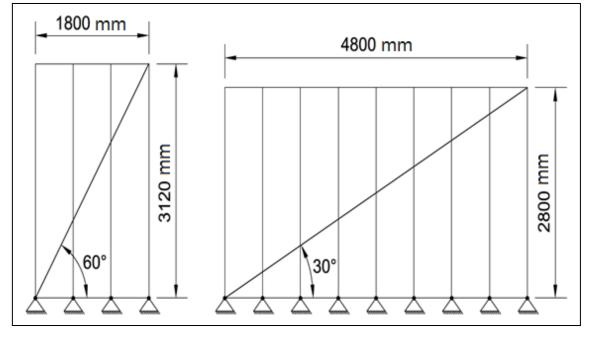
Figura 3.33 – Geometrias adotadas para o modelo de diagonal equivalente
