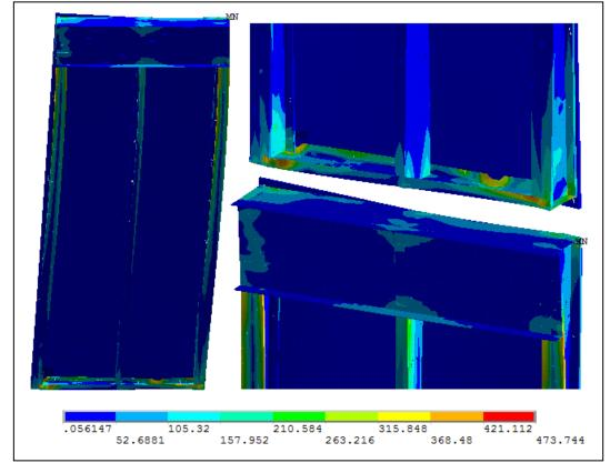
Figura 4.20 - Tensões de Von Mises atuantes no painel
