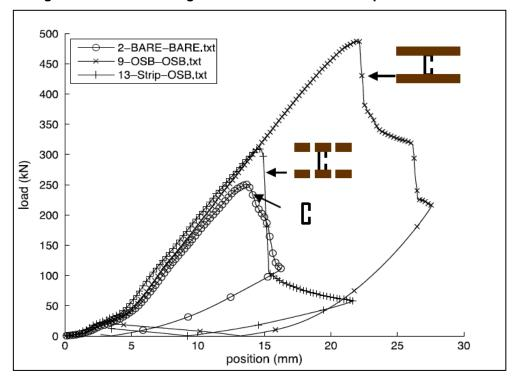
Figura 3.30 - Curvas carga versus deslocamento dos painéis ensaiados
