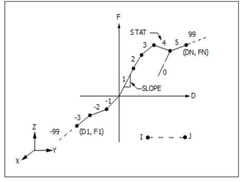
Figura 4.3 - Elemento finito Combin39
