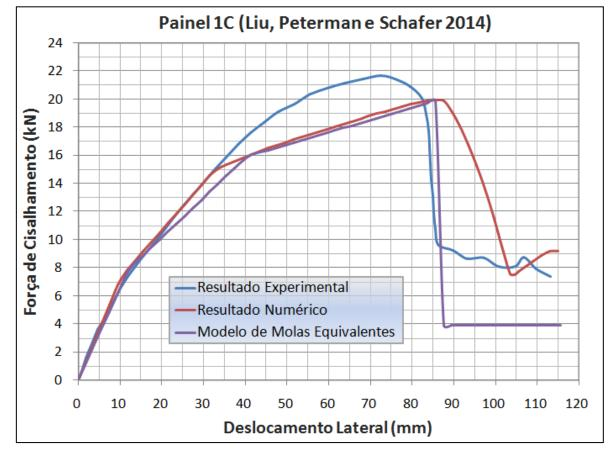
Figura 5.8 - Resposta obtida a partir do modelo de molas equivalentes
