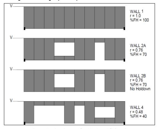
Figura 3.3 – Configurações dos painéis de cisalhamento ensaiados
