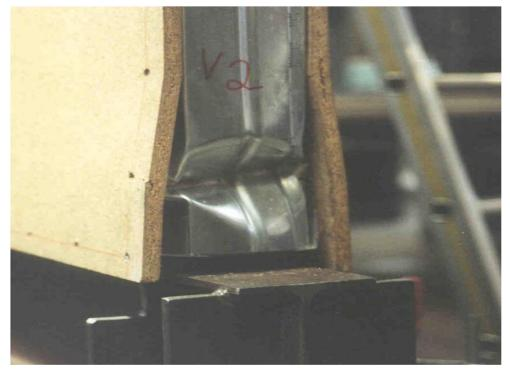
Figura 3.10 – Flambagem local na região inferior do montante comprimido
