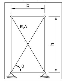
Figura 3.35 - Modelo simplificado para painéis de cisalhamento
