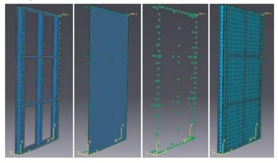
Figura 3.22 - Modelo de elementos finitos de um painel de cisalhamento
