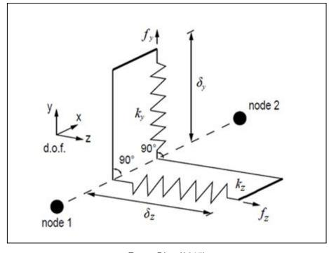
Figura 4.6 - Modelo de molas desacopladas
