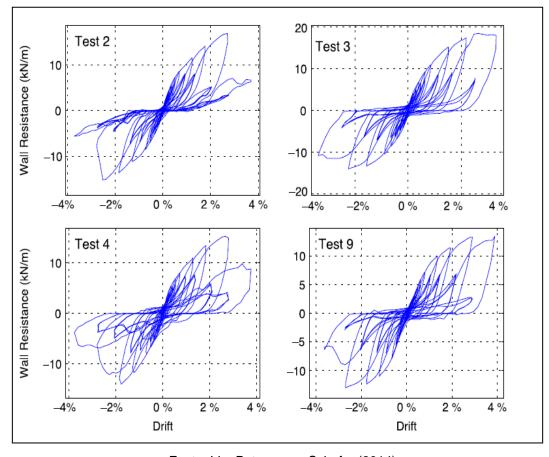
Figura 3.17 – Resposta histerética dos painéis caracterizada pelo modelo EEEP
