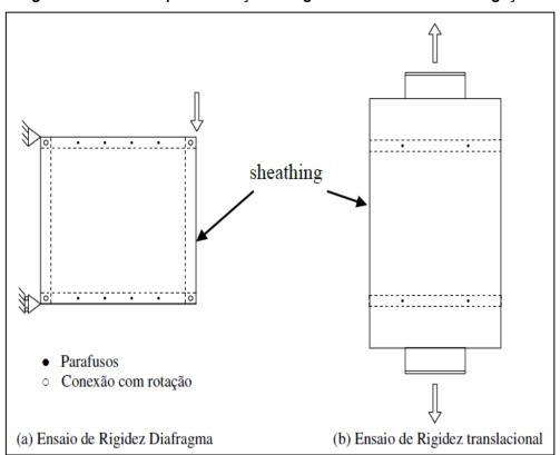
Figura 3.2 – Ensaios para obtenção da rigidez lateral de mola das ligações
