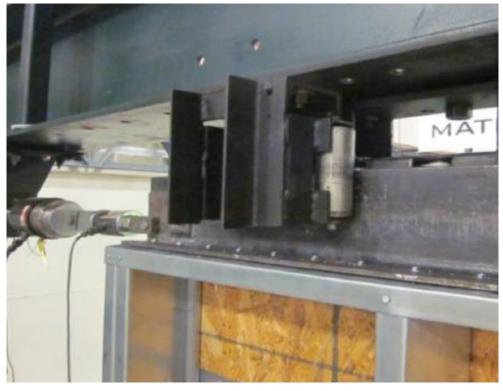
Figura 3.16 - Detalhe do sistema de suporte fora do plano
