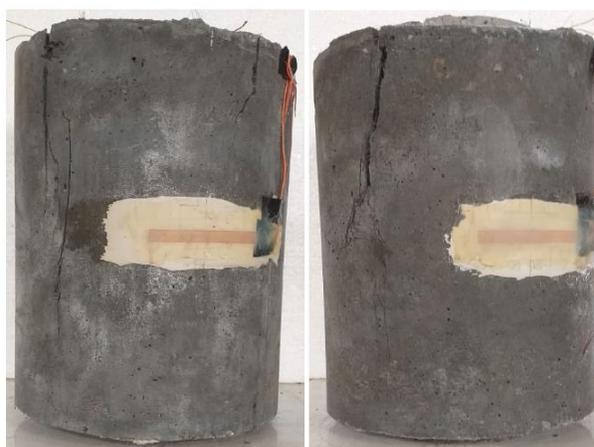
**Figura B.0.6 – Modelo com C60 e 3,5 cm de reforço**
