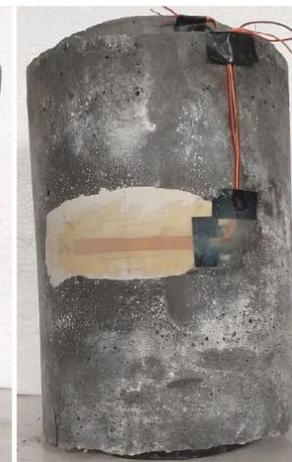
**Figura B.0.4 – Modelo com C25 e 3,5 cm de reforço**
