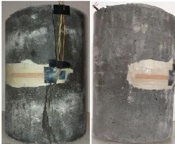
**Figura B.0.3 – Modelos com C60 e 2,5 cm de reforço**
