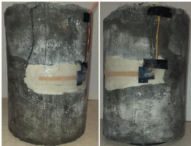
**Figura B.0.2 – Modelos com C40 e 2,5 cm de reforço**
