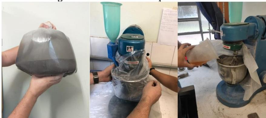
Após a mistura dos componentes (cimento, areia, pó de quartzo e sílica ativa), adicionou-se a parcela de água referente a um fator de água/cimento ( $a/c$ ) de 0,20 com o superplastificante diluído, a adição da água ocorreu com o misturador em velocidade lenta. Na sequência, deixou o misturador em velocidade alta por 5 minutos. Nessa etapa, conforme a mistura ganhava consistência era feito acréscimo de água levando a mistura para um fator  $a/c$  de 0,22 ou 0,24.
