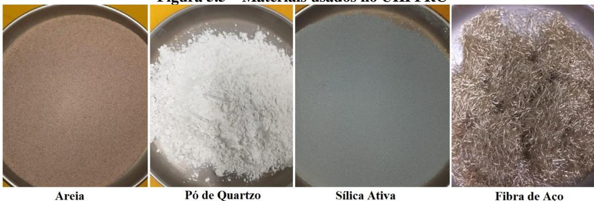
A fibra de aço usada possuía 13mm de comprimento, com diâmetro de 0,2 mm e resistência à tração de 2850 MPa produzido pela empresa Ganzhou Daye Metallic Fibers Co. Ltda. A porcentagem de fibra adotada para a mistura é de 2% do volume. Esse volume é suficiente para a obtenção de um comportamento à tração satisfatório, sem comprometer muito a fluidez da mistura, conforme apresentado no Capítulo 2.2.4.
