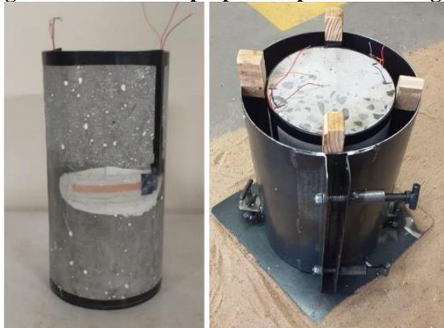
**Figura 5.11 – Forma de moldagem**
