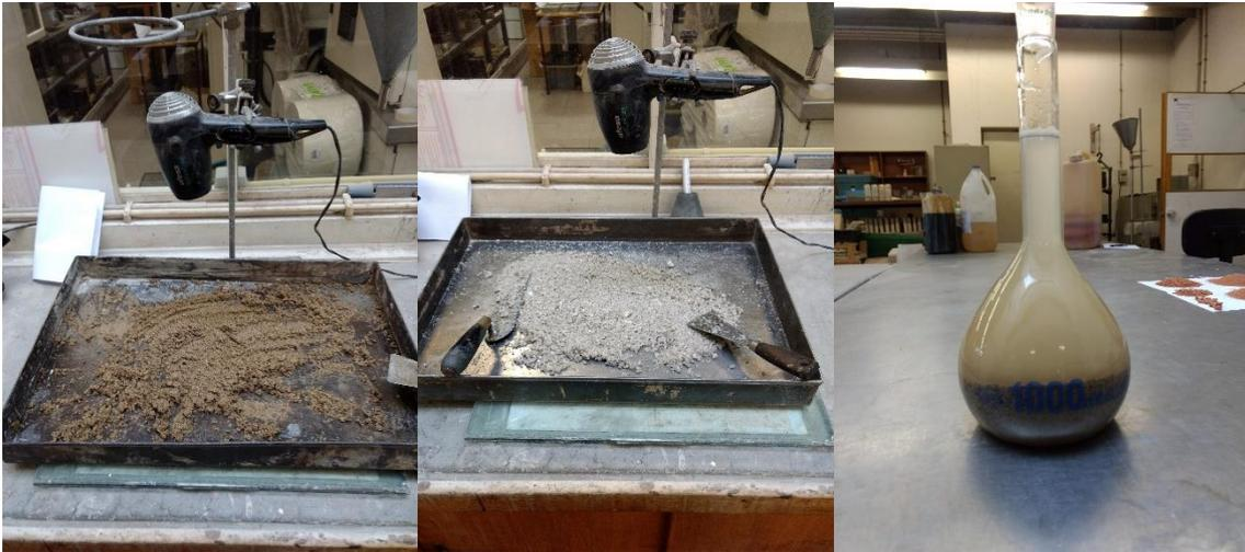
Figura 16 - Ensaio de absorção de água dos agregados
