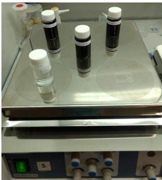
Figura 25 – Equipamento para agitação mecânica das soluções
