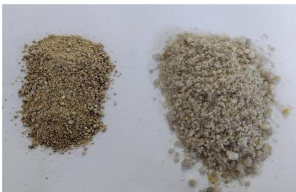
Figura 12 - Aspecto visual dos dois tipos de agregados miúdos utilizados
