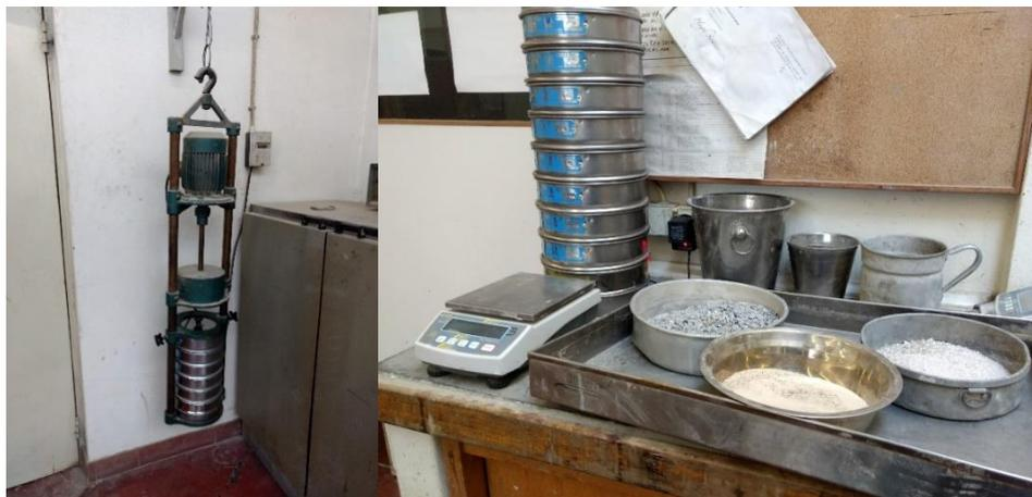
Figura 17 - Ensaio de granulometria dos agregados
