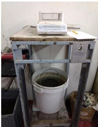
Figura 35 – Processo de obtenção da massa hidrostática dos corpos de prova
