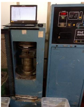
Figura 36 - Ensaio de compressão axial
