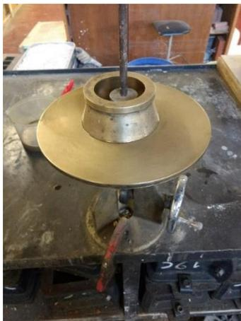
Figura 32 - Ensaio de espalhamento do concreto fresco
