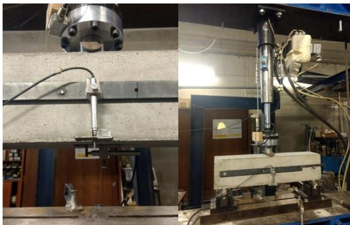
Figura 42 - Execução do ensaio de flexão
