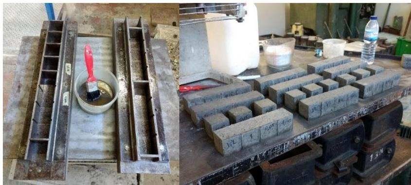
Figura 33 – Fôrmas metálicas e aspecto dos corpos de prova após a moldagem
