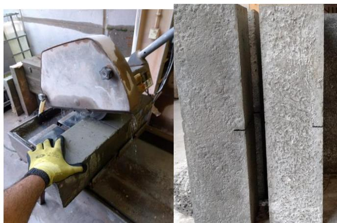
Figura 41 - Execução dos entalhes nos corpos de prova prismáticos segundo a EN 14651 (2007)
