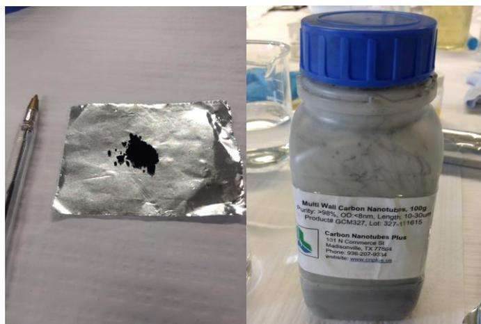
Figura 22 - Aspecto visual dos NanoTubos de Carbono (CNTs)
