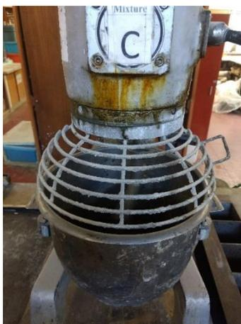
Figura 31 - Argamassadeira utilizada na produção dos concretos
