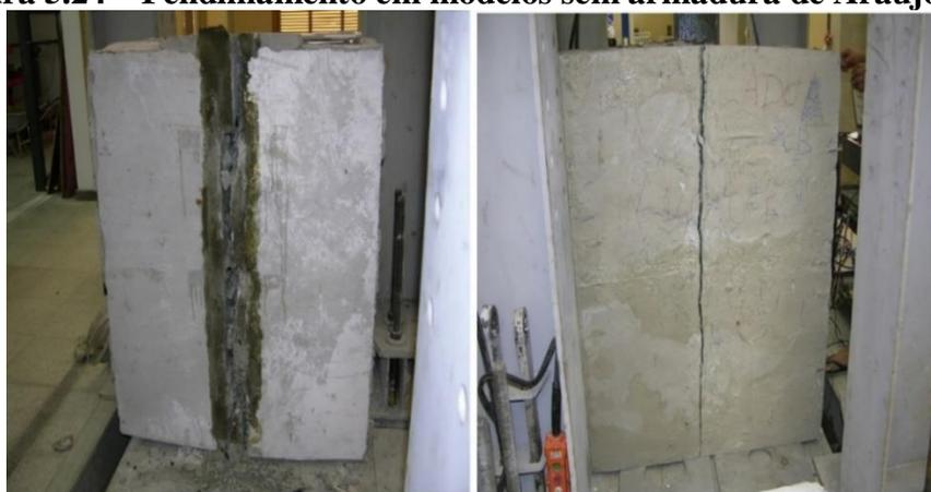
(a) Ruptura no concreto do modelo M-210-0 (b) Ruptura no concreto do modelo M-160-0
