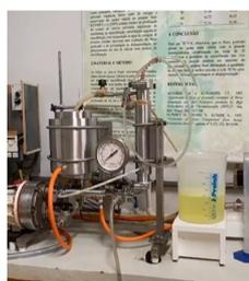
Sistema de separação por membranas
